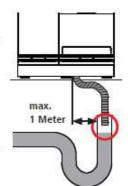
Lochdurchmesser 70mm für Wassereingang und -ablauf. Auch für Netzkabel möglich.
